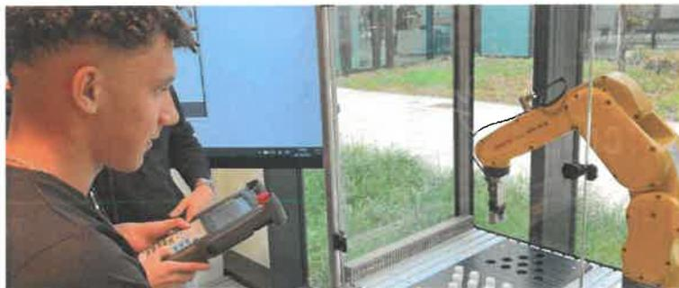
Un braccio meccanico montato su una cella trasportabile: il robot Fanuc ER-4iA è dotato di software di simulazione offline RoboGuide, validato da un percorso di formazione ed esercitazione alla fine del quale i ragazzi diventeranno "tecnici della robotica", professionisti che gestiscono, monitorano, mantengono i robot sulle linee produttive
